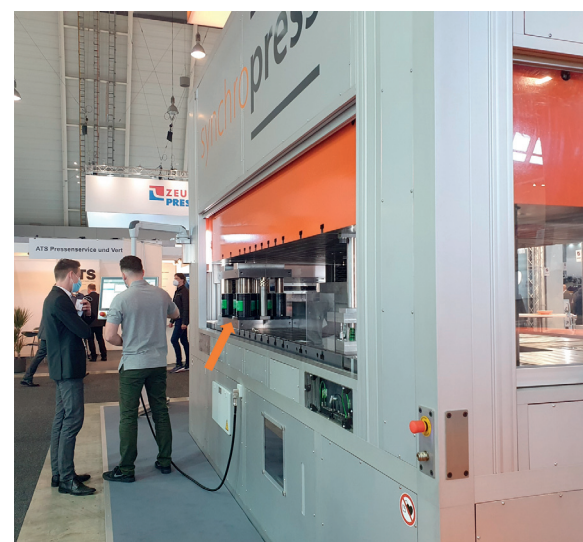
Bild 2: Gasdruckfeder-Werkzeug mit Kraftbedarf 850 kN außermittig auf der synchropress® 4M-4000
